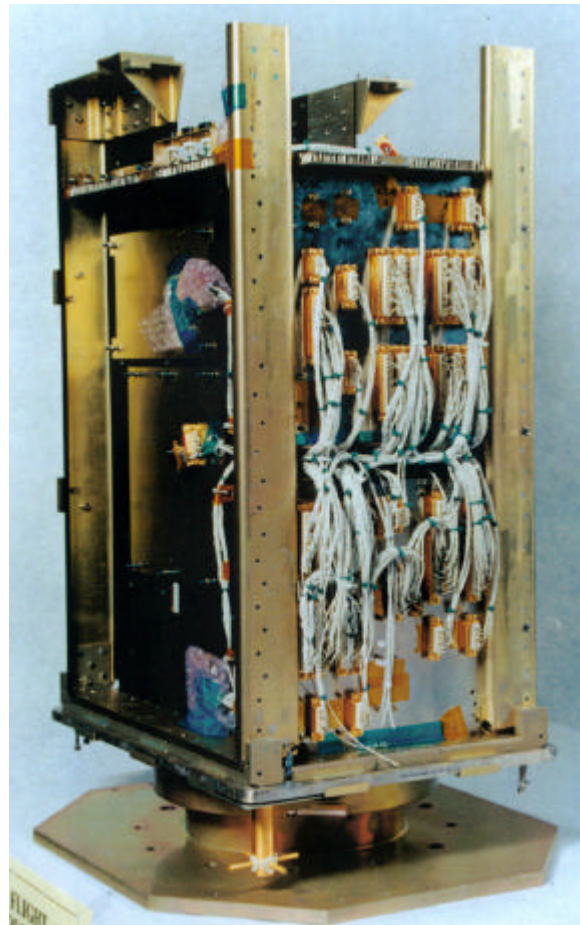
Fig. 8.2-2 Ørsted satellitten fuldt monteret, men uden solpaneler
